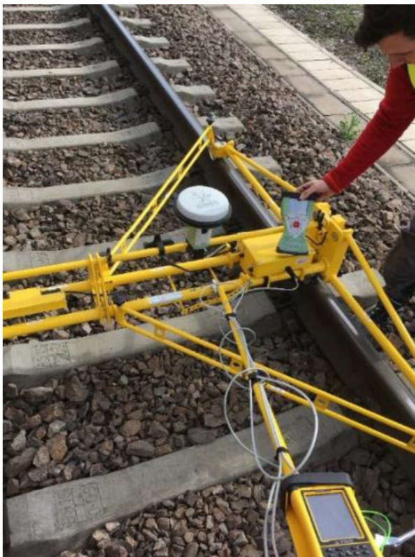
Obr. 11. Meranie geometrickej polohy koľaje
