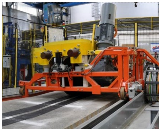
Obr. 8. Zrýchlené testovanie vozoviek
