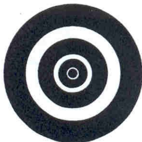
Obr. 6.27. Značka pre umelú signalizáciu vlícovacích bodov
