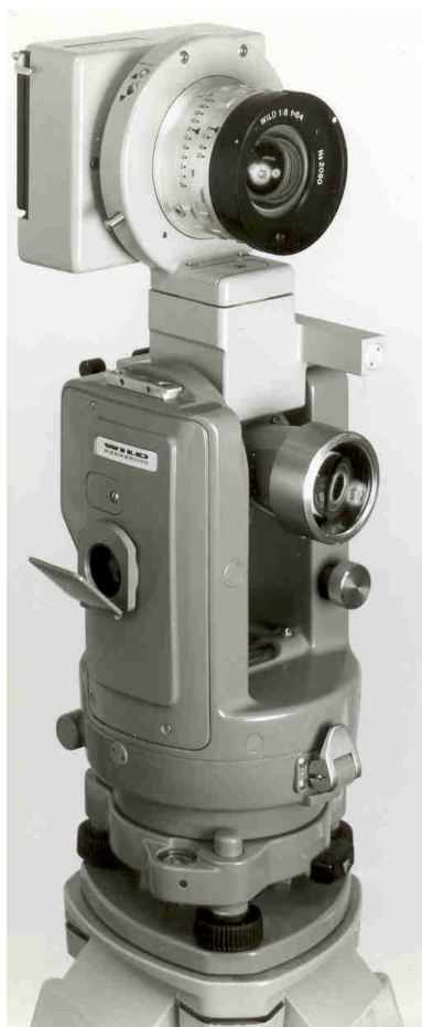
Obr. 6.2. Komora P 32 v spojení s teodolitom Wild T 16
