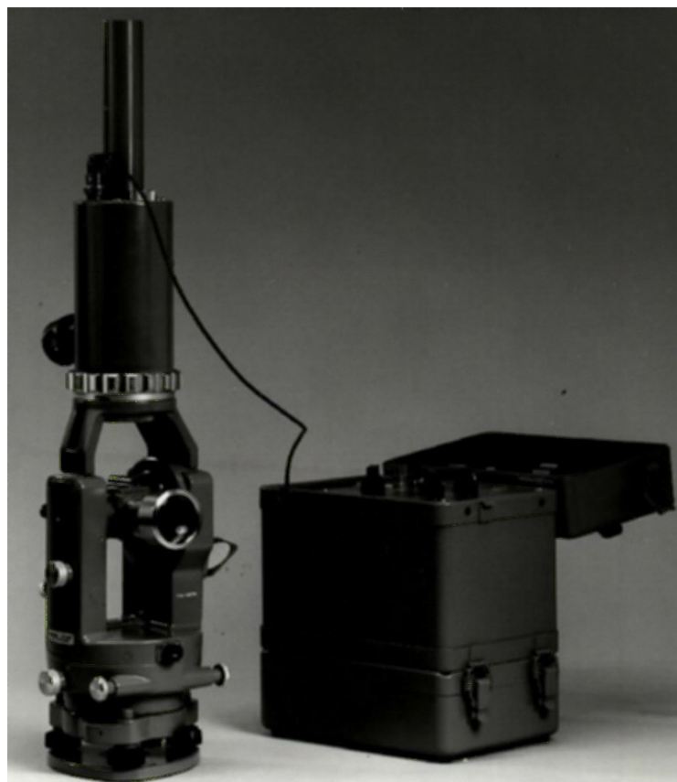
Obr. 4.61. Gyroskopický nadstavec Wild GAK 1 v spojení s teodolitom Wild T 2
