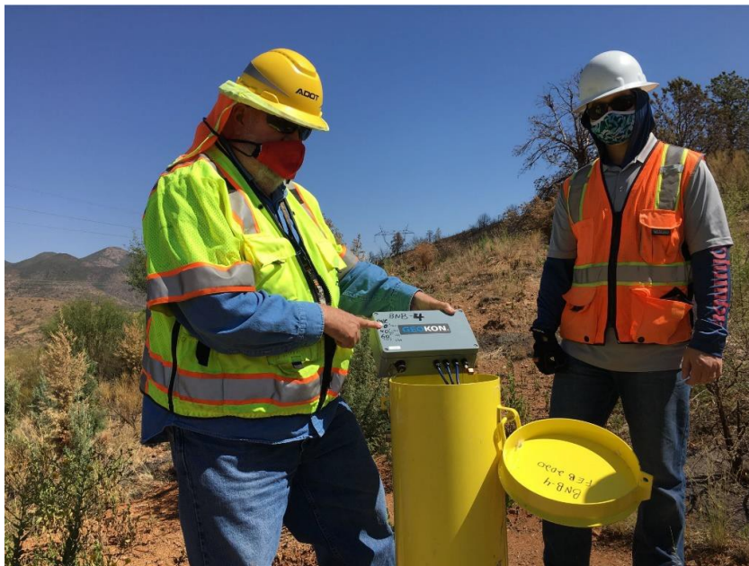
Obrázok 7: Sonda umiestnená v inklinometrickom stĺpci
