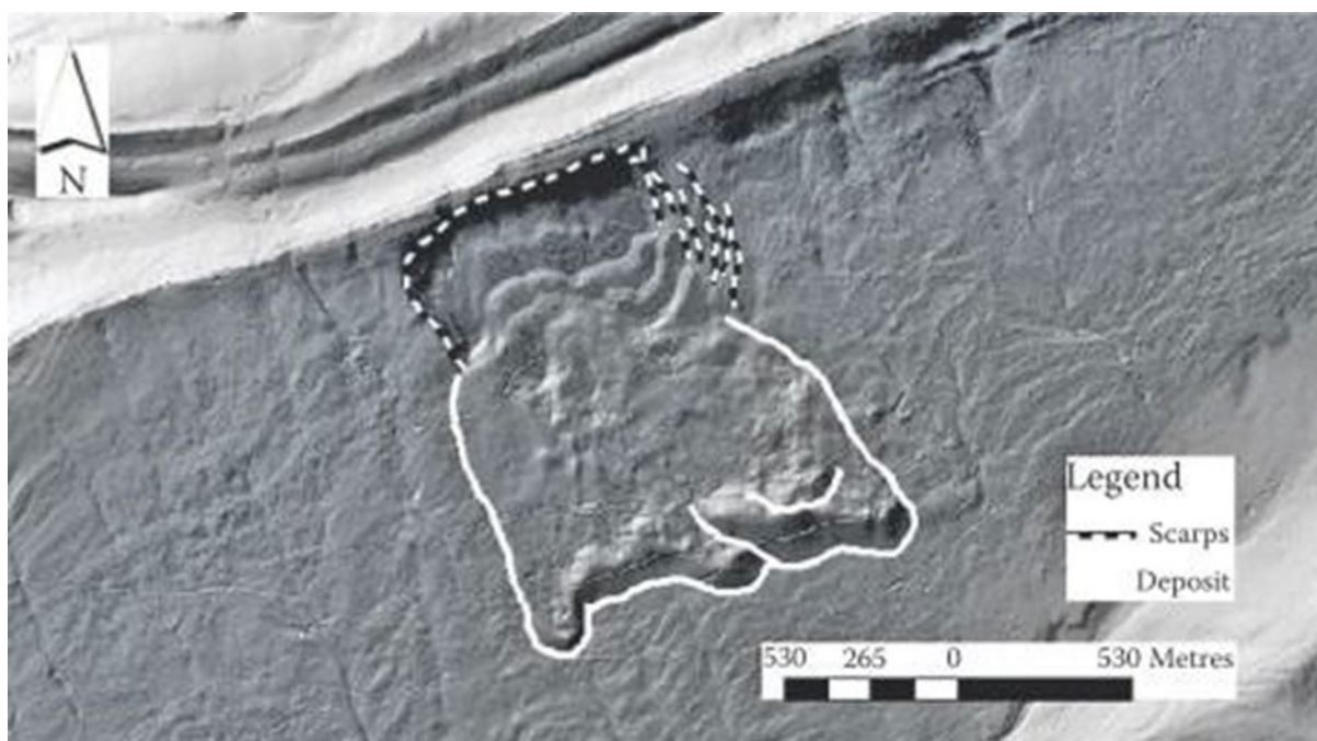
Rycina 8. Model terenu osuwiska oparty na danych LIDAR.
