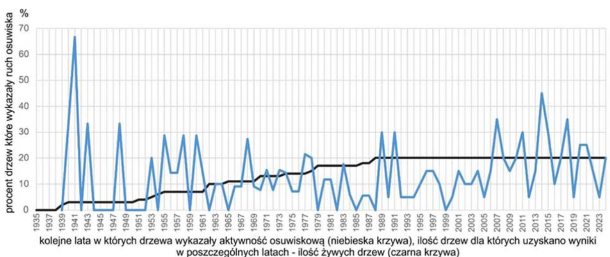
Obrázok 6: Graf zobrazujúci zmeny zosuvnej aktivity na skúmanom svahu v nasledujúcich rokoch zistené dendrochronologickou metódou.
