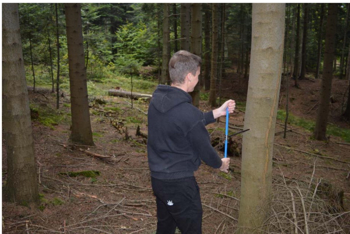
Obrázok 5: Odober vzorky jadra zo stromu pomocou Presslerovej vyvrtávačky počas terénneho testovania
