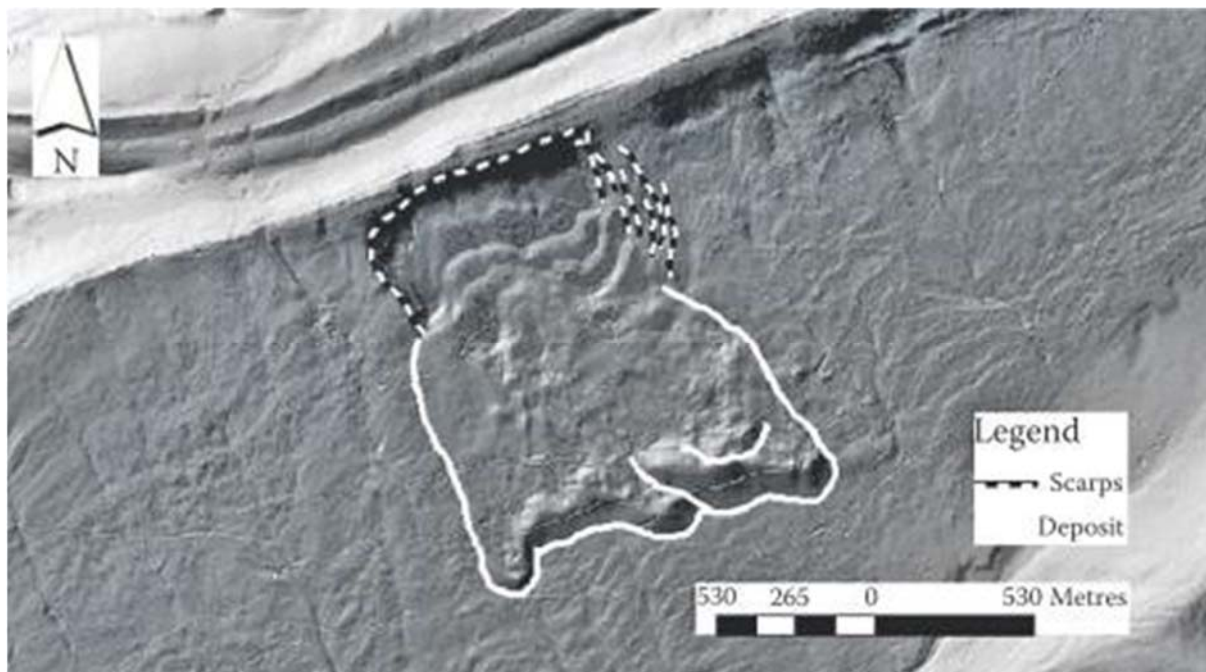
Obrázok 10: Model terénu so zosuvom pôdy založený na údajoch LIDAR.
