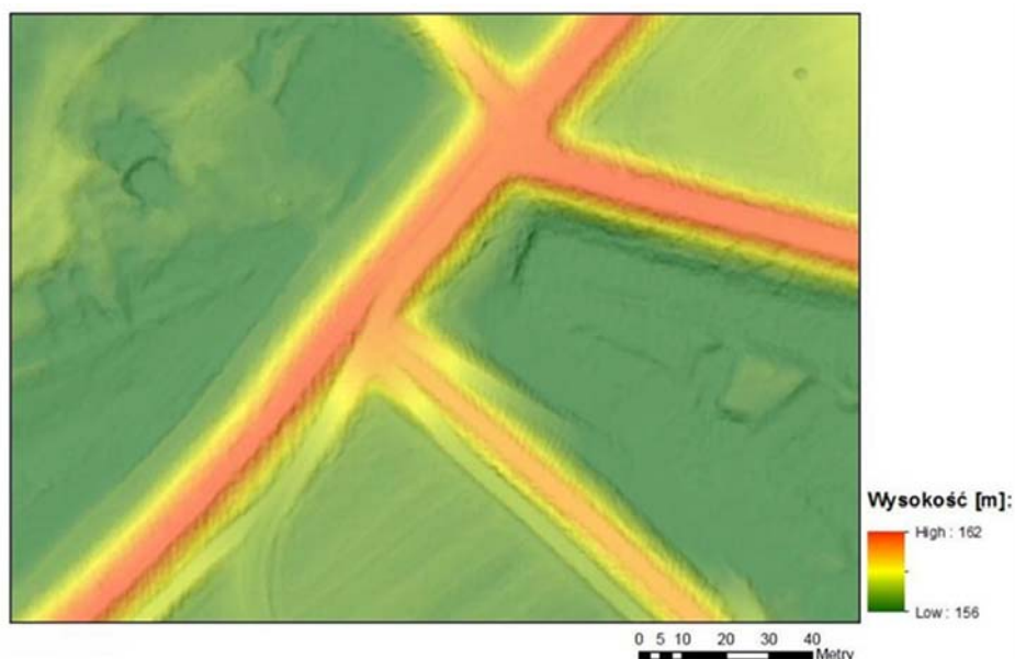
Obrázok 8: Príklad snímky získanej superponovaním tieňovaného modelu a hypsometrických farieb - získala sa podrobná topografia hrádze (Kurczyński Z., Bakula K., 2016).
