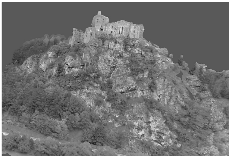
Obr. 10 3D model hradu Strečno a skalného brala získaný laserovým skenovaním
